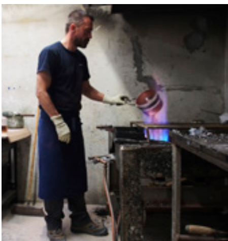
Étamage et rivetage, deux étapes essentielles dans la fabrication.
